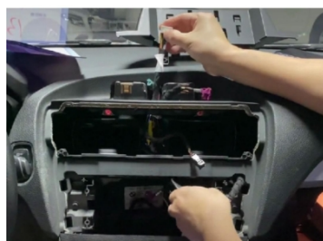
13. Führen Sie das neue Netzteil von oben nach unten heraus
