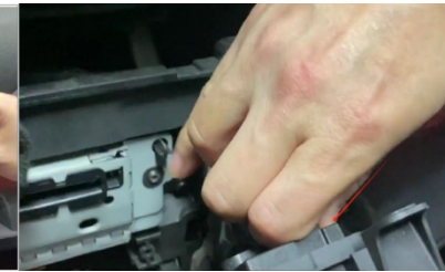
5. Entfernen Sie die Original-Fahrzeugverkleidung
