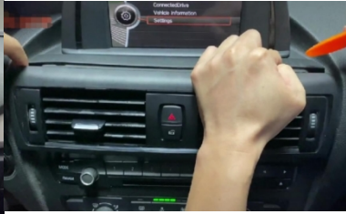
2. Den Luftauslass des Originalfahrzeugs aufhebeln
