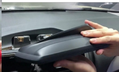
11. Ziehen Sie den Bildschirm von oben nach unten heraus.
