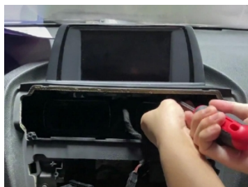
10. Lösen Sie die beiden Schrauben, mit denen der Original-Autoschirm befestigt ist.
