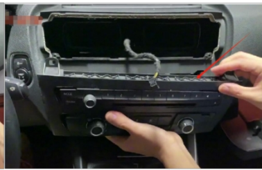
5. Entfernen Sie die Original-Fahrzeugverkleidung
