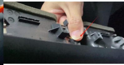
3. Ziehen Sie den Stecker auf der Rückseite des Luftauslasses ab
