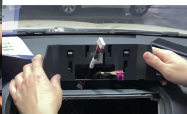
14. Installieren Sie die neue Basisordnungsgemäß das LVDS-Kabel in den neuen Bildschirm
